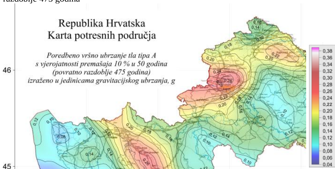
Slika 2: Izvod iz Karte potresnih područja u RH; Poredbeno vršno ubrzanje tla tipa A, povratno razdoblje 475 godina
